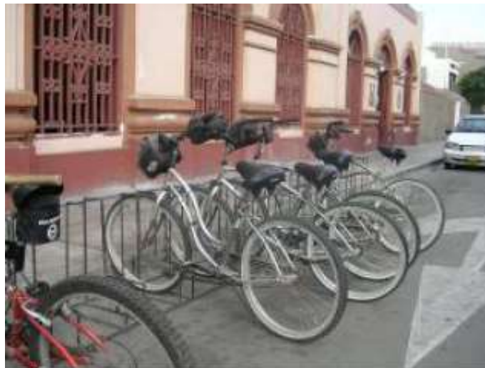
Fotografía 8.5 Estacionamiento horizontal de sujeción vertical
