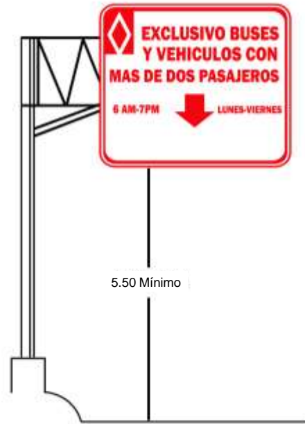
Figura 2.8 Señal reglamentaria elevada Tipo "bandera" con superelevación
